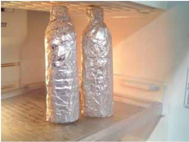
圖十 水樣保存：將自來水放置冰箱，停止自來水因時間的變化(文獻建議)。
