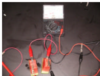
測量電壓、電流
