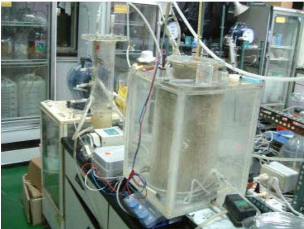
圖二十、連續式產氫反應器裝置圖
