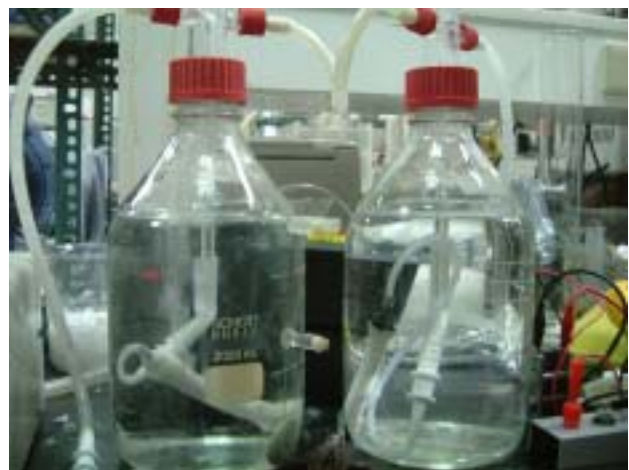
圖十四、氫氣純化裝置（以 NaOH 吸附 CO 2 ）
