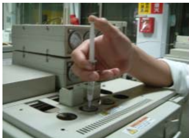
圖十二、層析儀分析氣相之組成濃度
