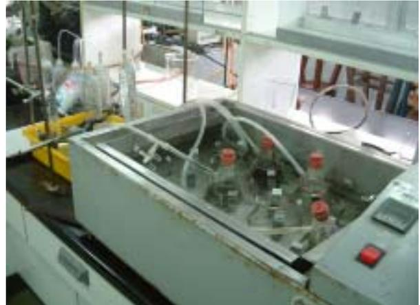
圖八、恆溫震盪水槽
