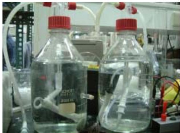
圖十四、氫氣純化裝置（以 NaOH 吸附 CO<sub>2</sub>）
