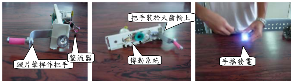
圖一 作品一，手搖發電單一小 LED 燈泡手電筒
