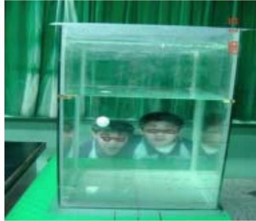
4、夜色來臨時，打開自製限光器，讓光束以不同角度入射水族箱內，我們看到了會「轉彎」的光。自製限光器是將遠照燈放入木板釘成的木盒而成，釘製木盒時需設計成遠照燈正好放入，以定位遠照燈，燈光射出時要先經過三道（兩道也可以）排成一直線的小圓孔，形成擴散性很小的光束。
