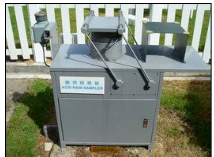
這台酸雨採樣器下雨時會自動掀開蓋子。
