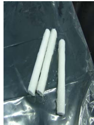
上圖表示： 用矽膠 (silicon) 將粉筆的四面黏住，只留兩端可滲透。
