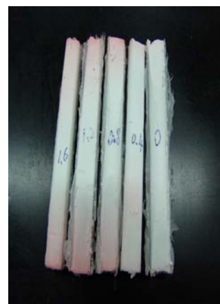
上圖表示： 從 1 大氣壓到 2.6 大氣壓顏色 是由淺到深且擴散距離加長。
