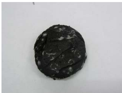
圖 57：發霉的炭塊 (木炭：硝酸鉀=4：1)
