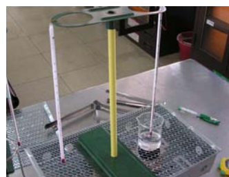
圖 41：改良測量水溫的方式與儀器裝置
