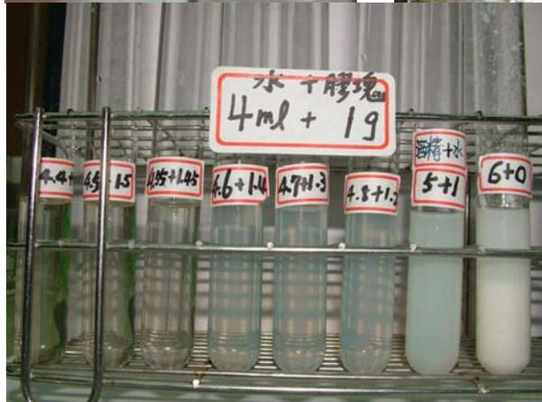
不同混合比例 (酒精:水:阿拉伯膠) 乾燥時間測試。
