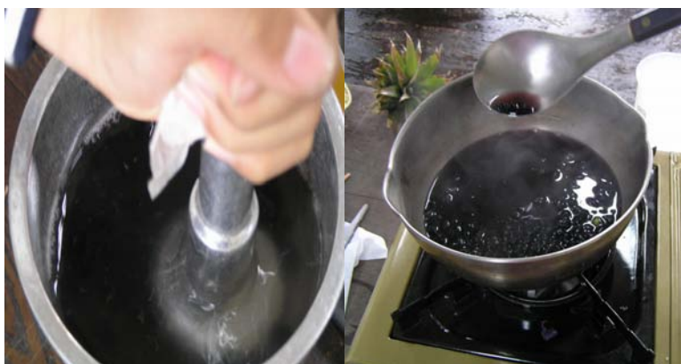
【圖十七】黑豆指示劑製作過程(先搗碎再用蒸餾水煮)
