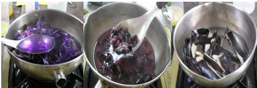
【圖十八】蒸餾水煮指示劑過程：由左而右為紫高、葡萄、茄子
