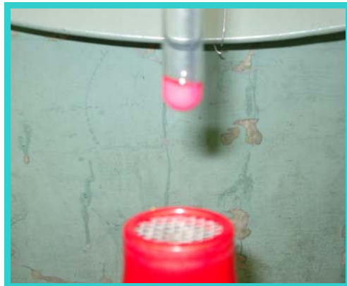
吹風機加熱，觀察試管中顏料膨脹情形
