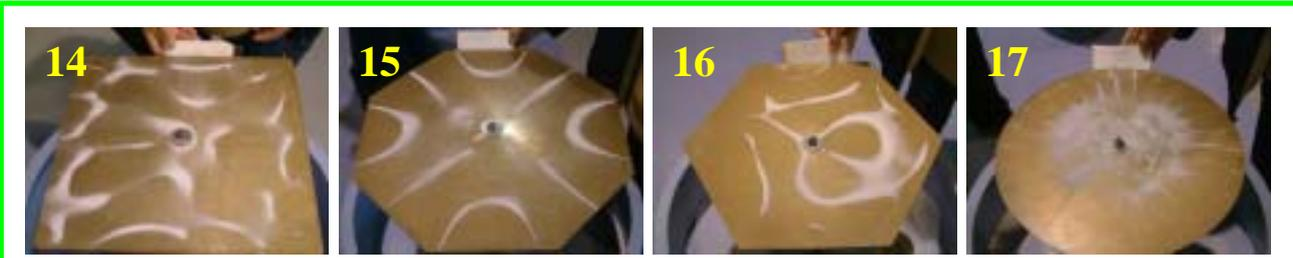
圖 12：正方形鋼板上的克拉尼圖形
