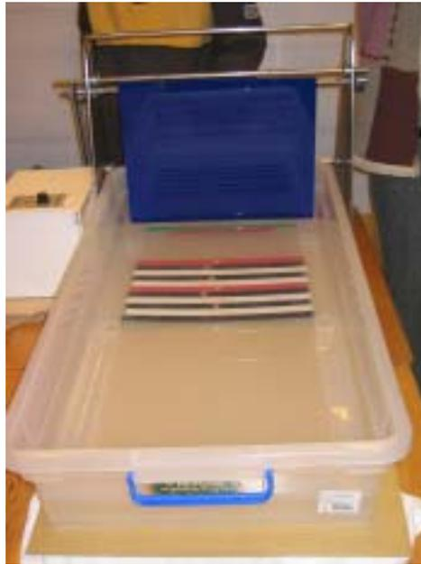
圖 5：貼上有色膠帶的水波槽
