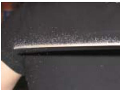
圖 11：觀察細玻璃砂受音波振動而跳動的情形
