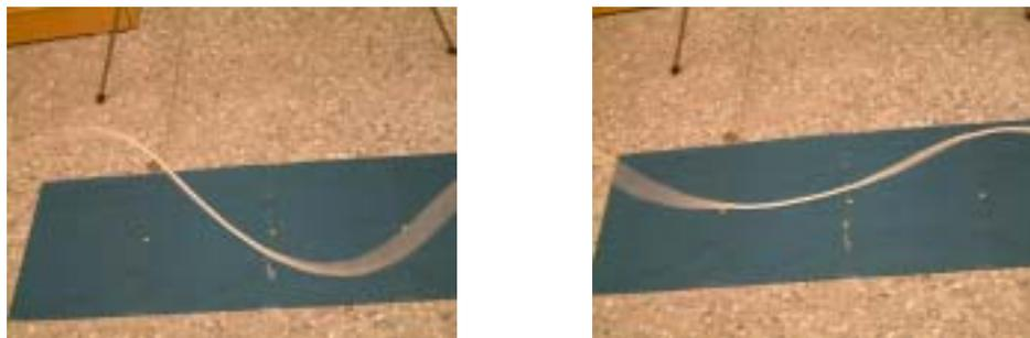
施力越大，波紋振幅越大且密度越高。 相遇處形成不動的節點。圖形稱為駐波。
