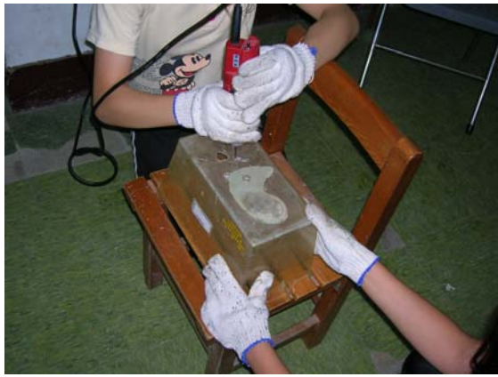
圖 3-5：在飼養箱的底部用電鑽鑽洞。
