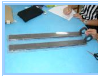
圖 20. 大磁輪在雙軌上運動
