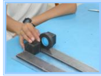
圖 21. 單顆大磁輪在單軌上運動 (單軌兩旁各加上 10 塊加速器)
