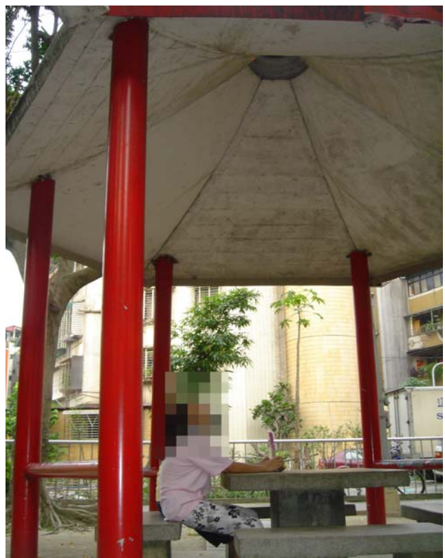
照片十 - H 以 71 度測得數據加桌子高度，求得涼亭高度約 3.65m (量測不規則物體)
