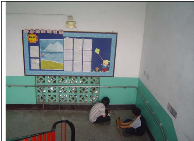
照片十二-F G 以可調角度測量器可以 1m 的底長 65 度的角度檢測看板兩端高皆為 2.14m
