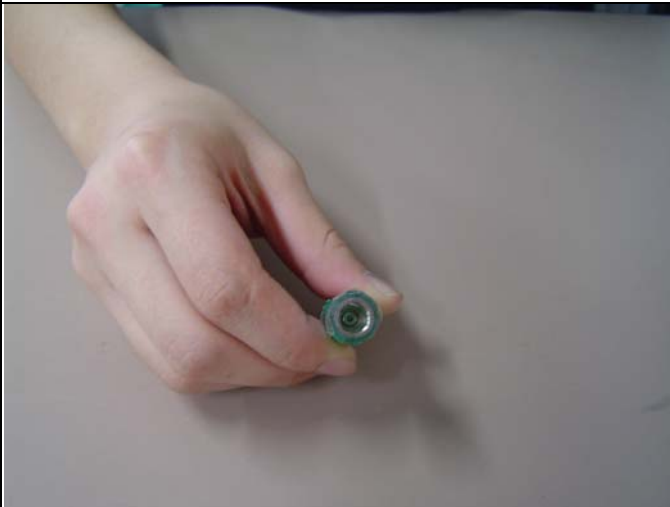
3 在除去鏡頭的雷射筆前黏上一根頭髮，作為 0.1 度指示刻度 照片九 -H
