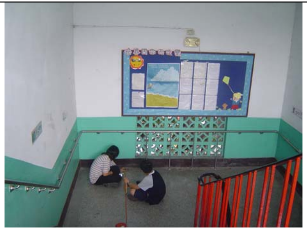
照片十二-F G 以可調角度測量器可以 1m 的底長 65 度的角度檢測看板兩端高皆為 2.14m
