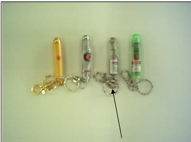
照片九 -A 在各種雷射筆中，可旋轉調整焦距式的雷射筆，能將前面聚光凸透鏡鏡片拆下
