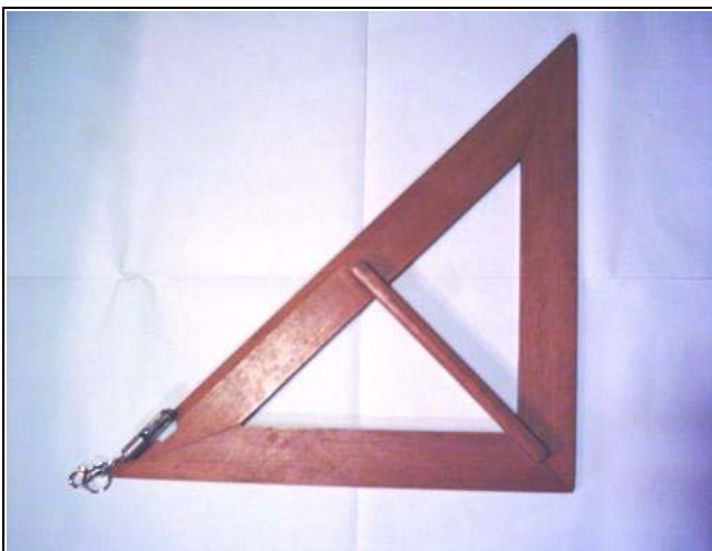
照片四-A 去年參加科展我們利用雷射筆、皮尺和直角等腰三角板自製簡易高度測量器，可順利測得約 20 公尺高的建築物
