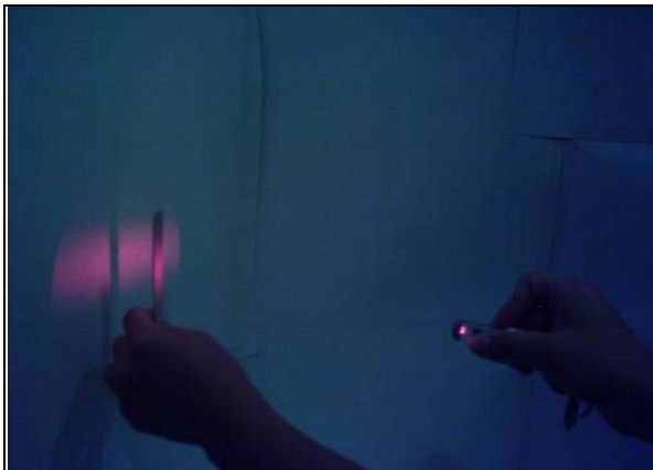
照片九 -C 可拆下聚光凸透鏡片的雷射筆物體呈像於接近布幕正前方，可清楚呈現影像與實物一樣大小
