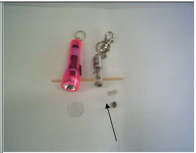
照片九 -B 右者為可拆下聚光凸透鏡片的雷射筆其光源可將物體清楚且等比例放大
