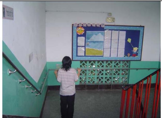
照片十二-F G 以可調角度測量器可以 1m 的底長 65 度的角度檢測看板兩端高皆為 2.14m
