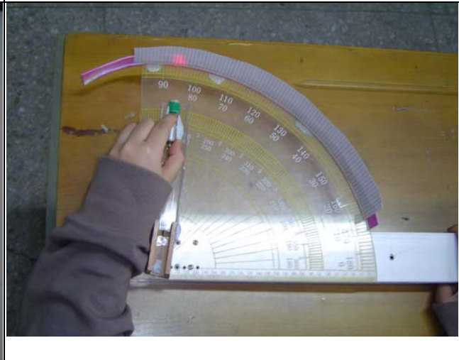
4 做一底座置固定除去鏡頭的雷射筆並與調整用雷射光源成一直線 照片九-I
