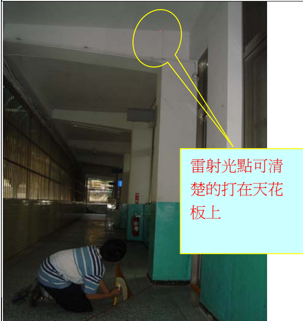
照片六-D 用可調角度測量器測量，以 1 m 底長 \times 角度倍率約 73 度，換算後測得教室高約 3.27m
