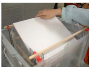
圖 5-13 將小型看板放入測量平臺
