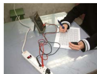
圖 5-18 計時約 20 秒並觀察電壓有否異常
