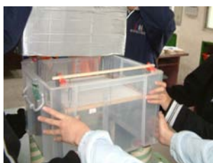
圖 5-14 檢查彈簧位置並準備與風洞相接
