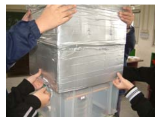
圖 5-15 測量平臺與風洞完成接合
