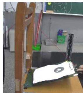
4. 當墊片滑落時，測量基準點至底的垂直距離
