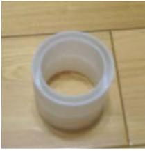
我們發現中間的圓剛好可以塞下外軸，可惜因為塑膠圓筒的外圓與內圓間的距離太短，會使得釘軸突出到塑膠圓筒的外面，所以無法使用。
