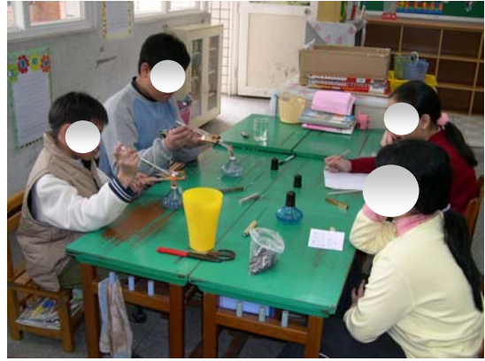
※分別加熱試管水面和水底測量溫度變化
