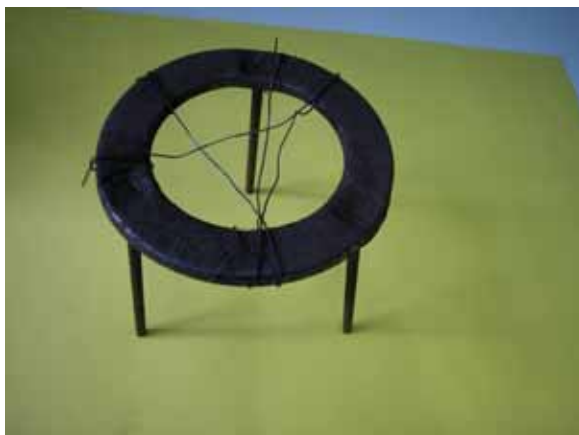
（圖 11）鐵絲綁出鐵網以固定加熱高度
