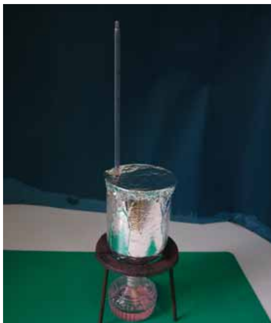
（圖 12）鋁箔包量杯酒精燈加熱法
