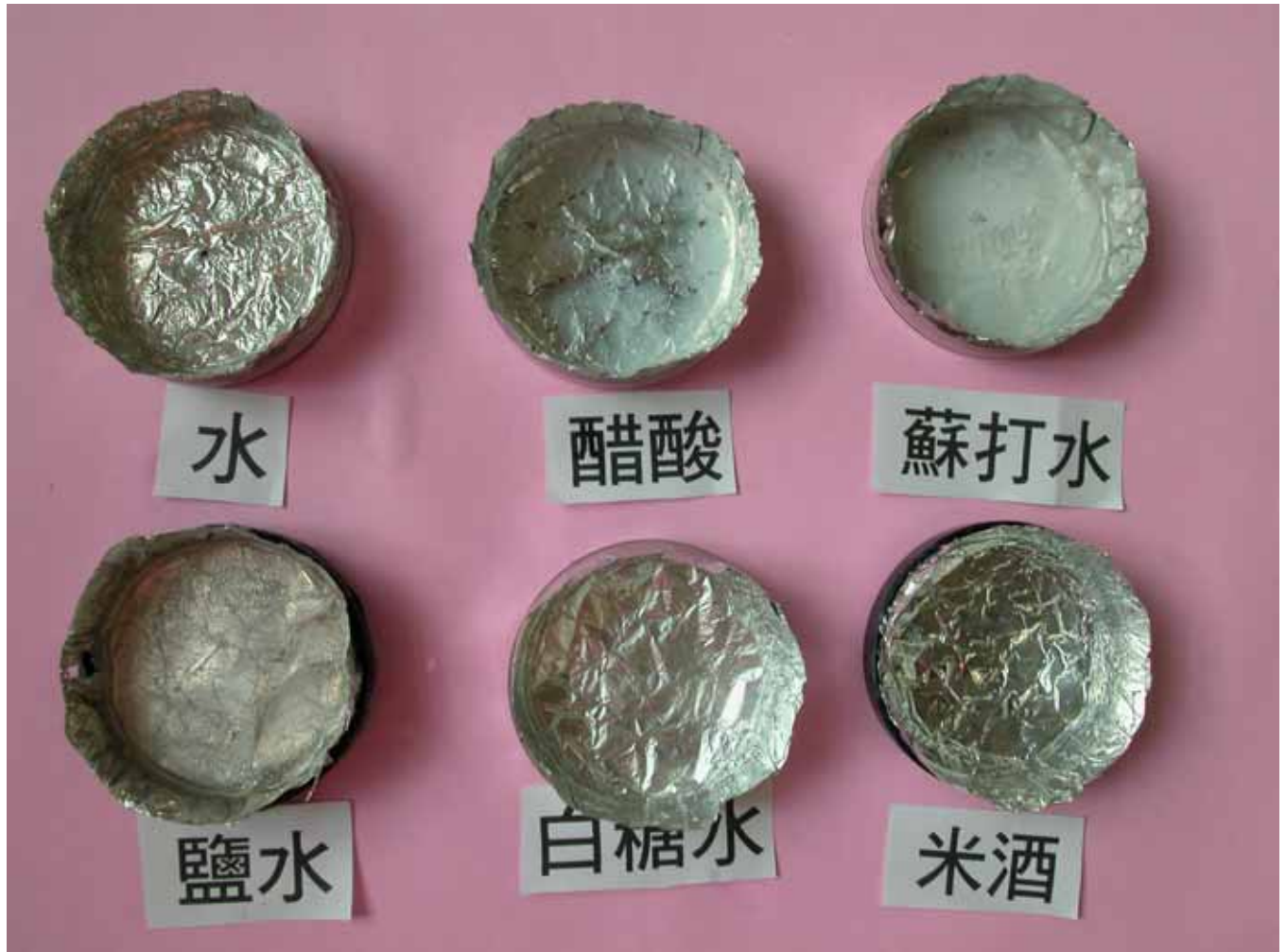
(圖 18) 各種溶液在鋁箔杯中加熱一週後產生白色膠狀物情形
