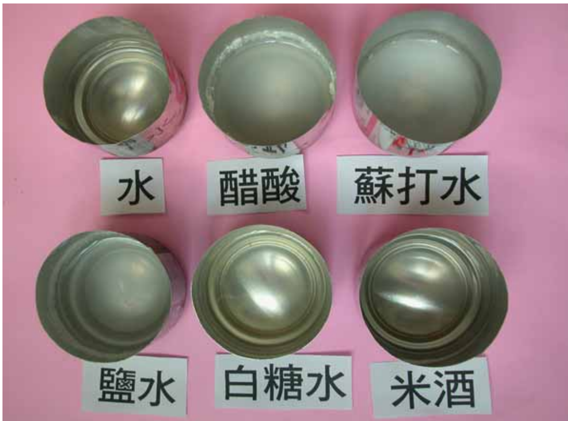
(圖 17) 各種溶液在鋁罐中加熱一週後產生白色膠狀物情形
