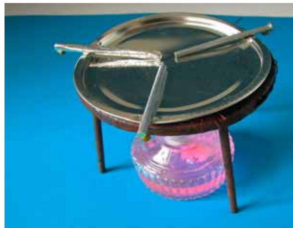
(圖 4) 我們設計的鋁箔棒、鋁棒、鐵棒傳熱器
