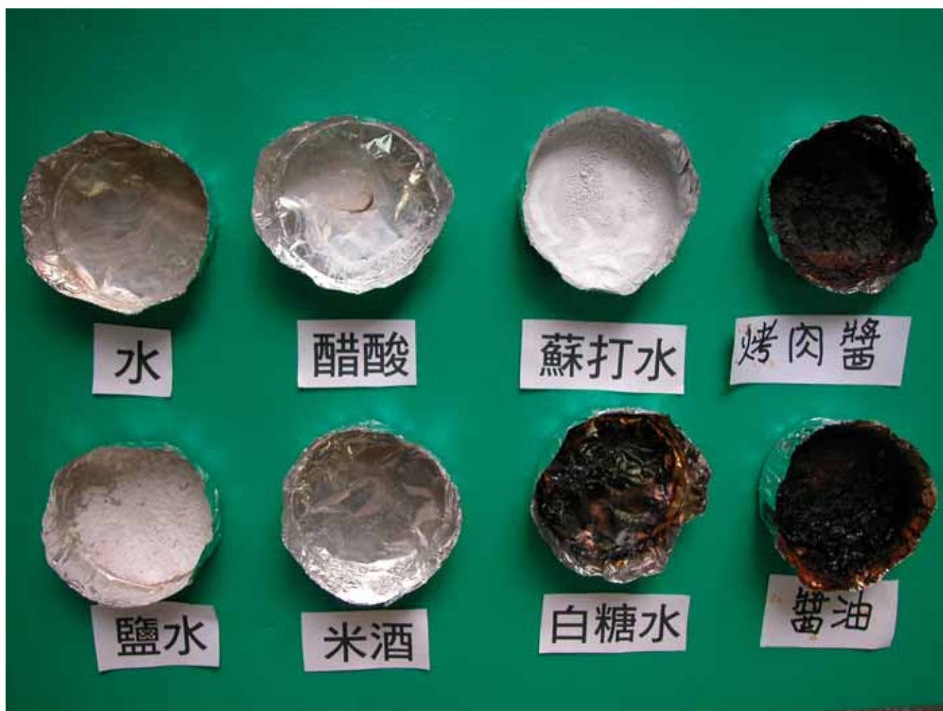
（圖 21）各種溶液在鋁箔杯中加熱情形蒸發燒焦情形
