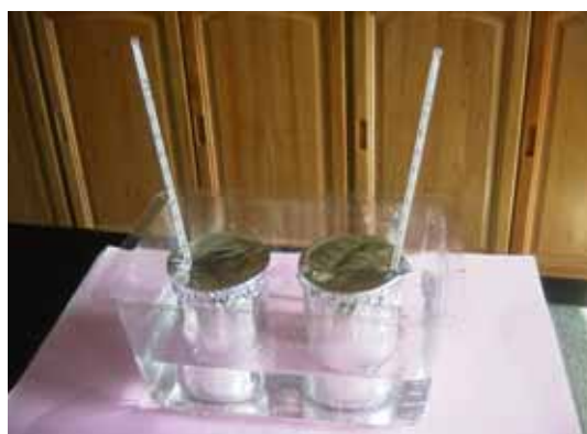
(圖 10) 鋁箔包大量杯放熱水盆內傳熱
