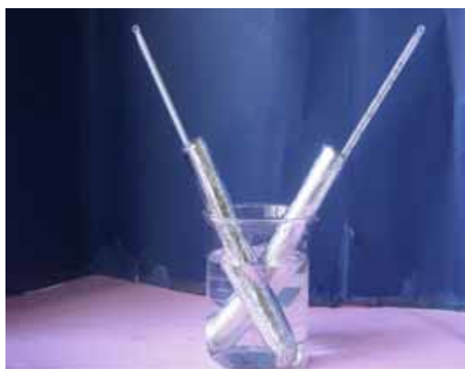
(圖 9) 鋁箔包試管放熱水盆內傳熱
