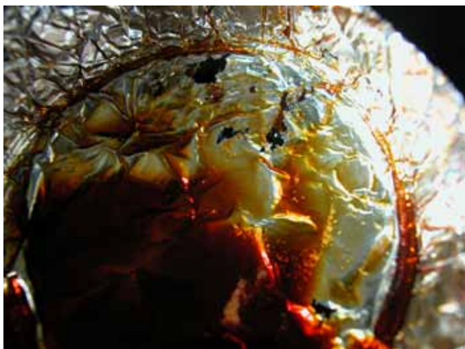
(圖 19) 醬油一天後就將鋁箔蝕出破洞
