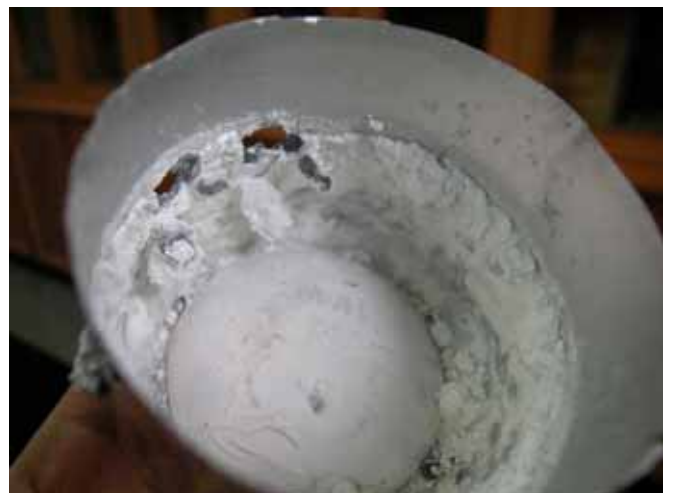
(圖 20) 醋酸將鋁罐蝕出破洞
