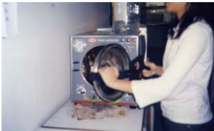
(圖八)操作高溫高壓滅菌釜
