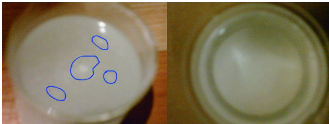
研磨 7 小時氧化鋁粉體溶液加入食鹽產生凝聚現象
