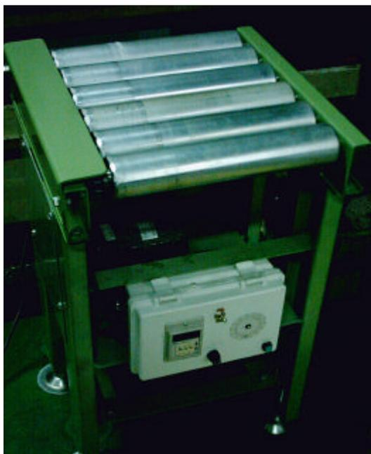
圖 4-1.自製滾動式研磨機完成圖
