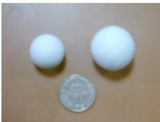
圖 6-1. D<sub>2.0</sub> 及 D<sub>2.5</sub> 的氧化鋁研磨球
