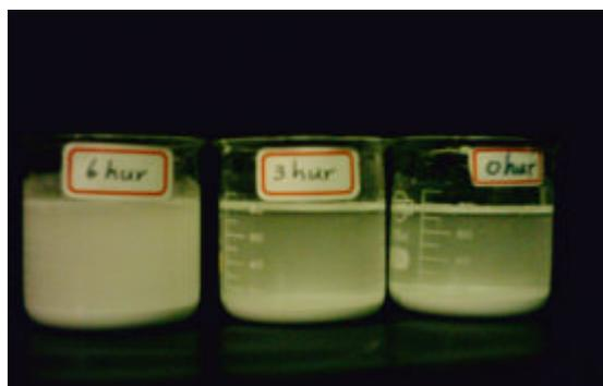
經過 3 分鐘後的氧化鋁粉體溶液之靜置試驗
