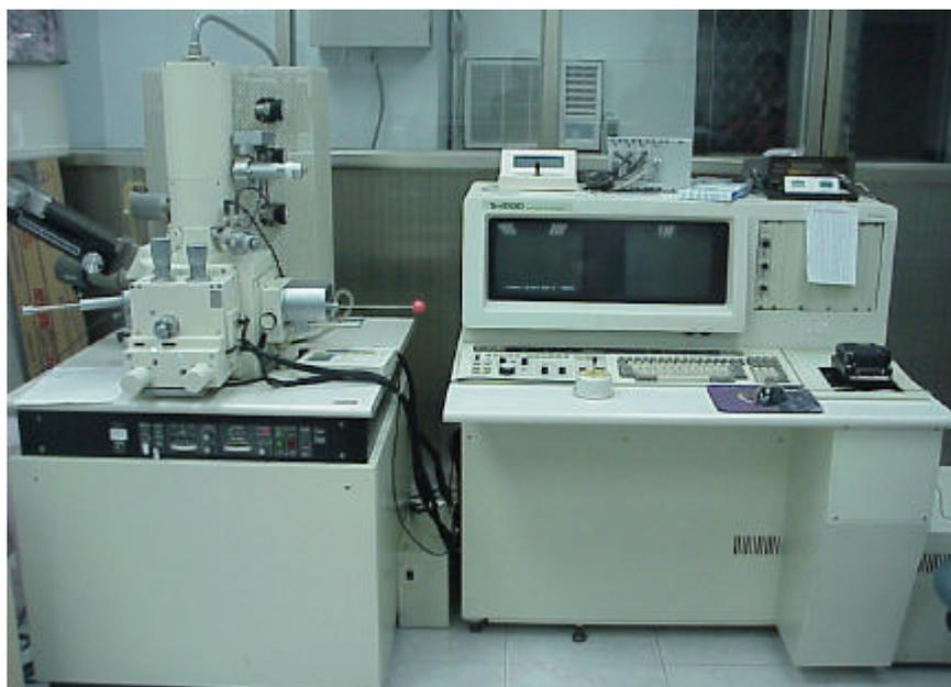
圖七 掃描式電子顯微鏡(Scanning Electron Microscope)
