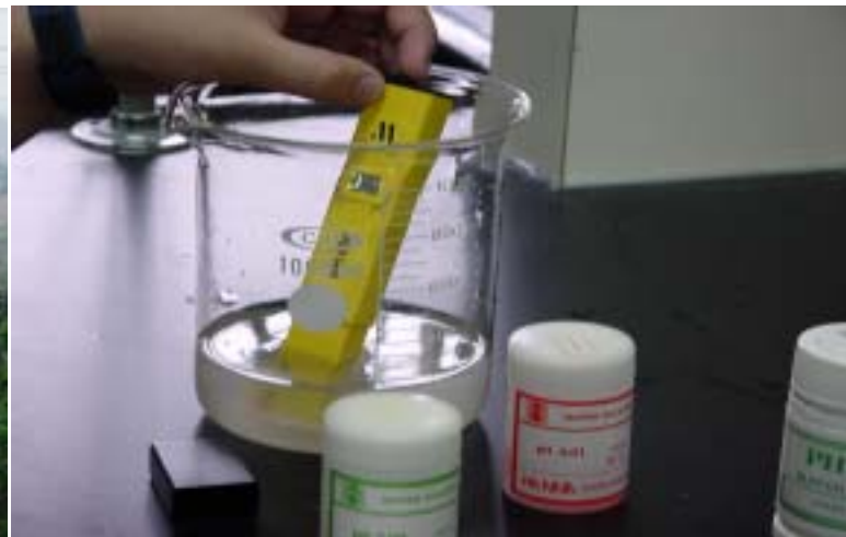
(照片 B-乙-10) 測水質酸鹼值
