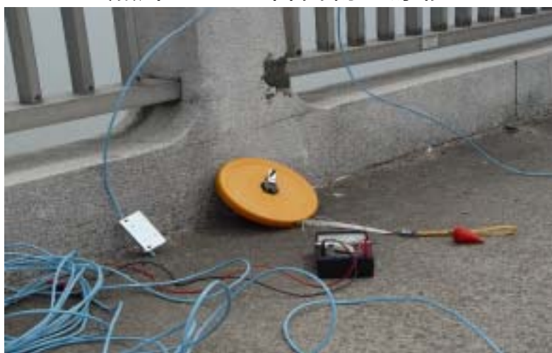
照片 B-乙-5 測河水的導電值
