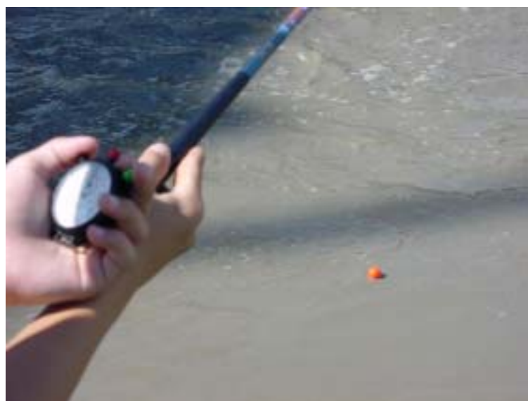
(照片 B-甲-3) 浮球測水流速
