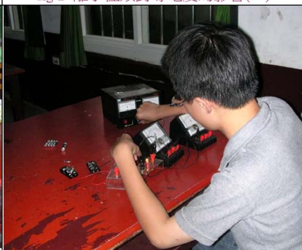
fig 4 測量電阻器的電阻 一 (歐姆定律)
