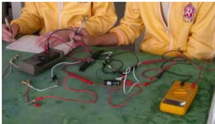
圖 1-1 鹼性電池與乾電池放電裝置圖
