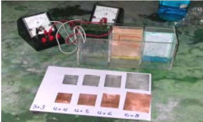
圖 3-2 不同接觸面積測量電流大小裝置圖
