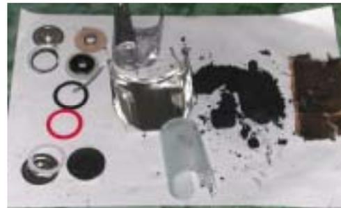
圖 2-2 鹼性電池內部拆解圖
