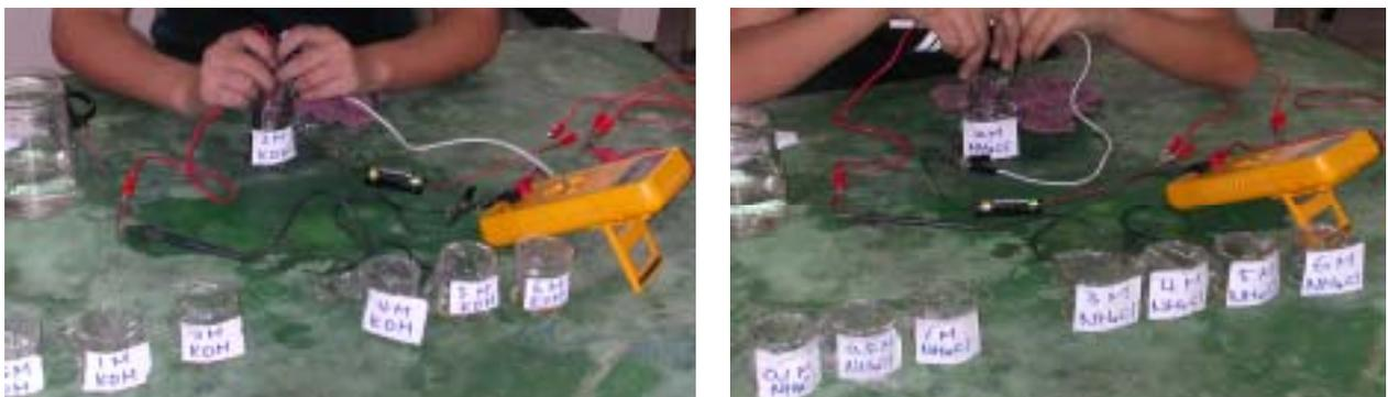
圖 3-3(a)、3-3(b) 不同濃度測量電流大小裝置圖
