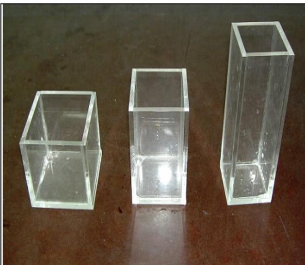
圖 (4-4) 同體積不同瓶口面積的壓克力容器
