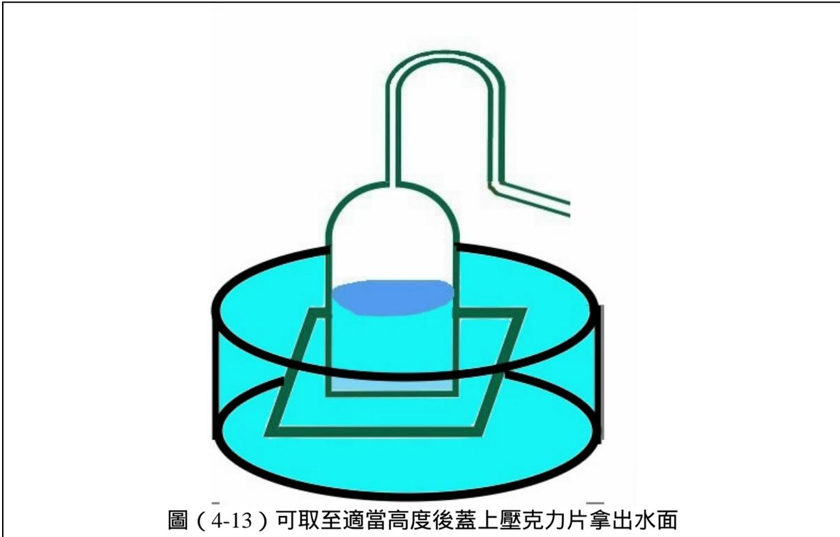
圖 ( 4-13 ) 可取至適當高度後蓋上壓克力片拿出水面
