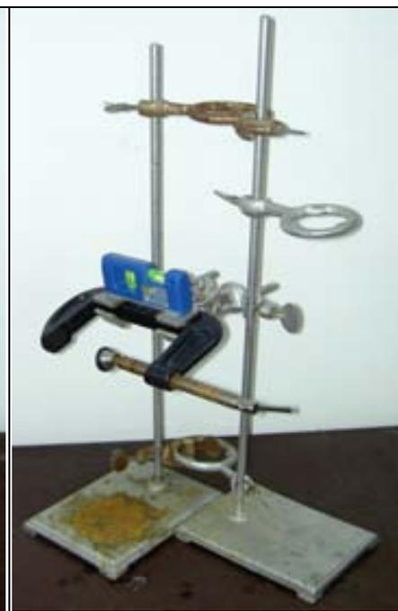
圖（4-3）加上可移動水平儀
