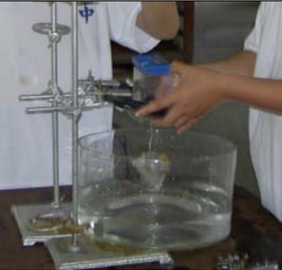
圖 (4-6) 裝好水調整水平後準備加砝碼
