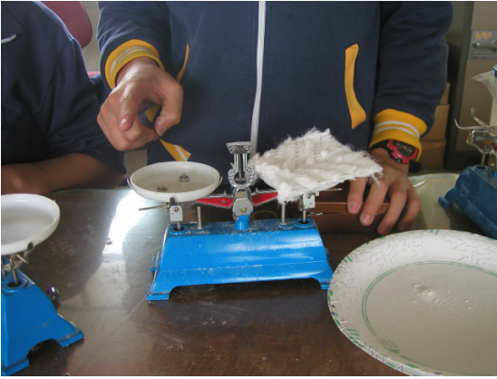
(步驟 1) 切割除塵紙大小為 10 cm×10 cm，並測量除塵紙的原始重量
