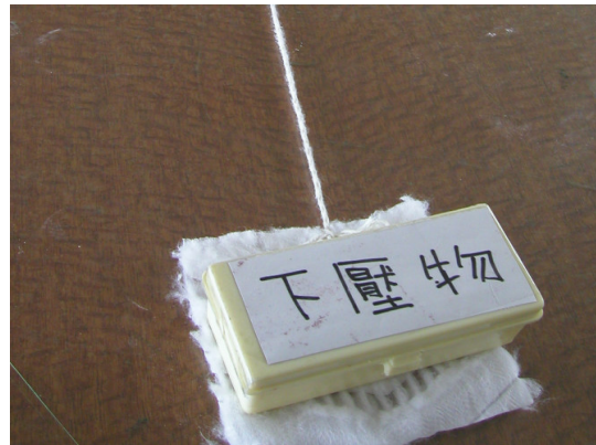
(步驟 4) 在除塵紙上方放置下壓物，兩者中間以膠帶黏合
