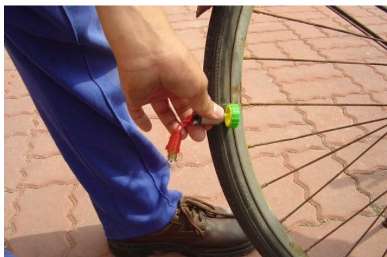
〈以大齒輪接觸腳踏車輪發電〉
