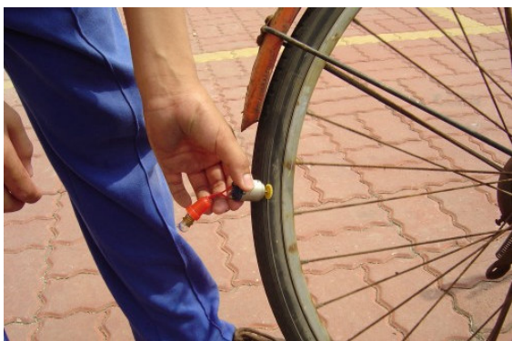
〈以小齒輪接觸腳踏車輪發電〉
