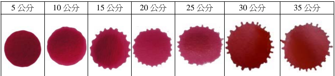
圖三：紅墨水在不同高度時，液滴在西卡紙上的圖形。
