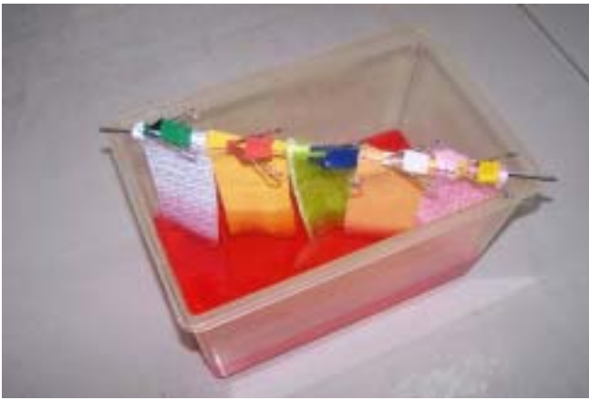
圖六、五種廚房抹布靜置水槽吸水情況
