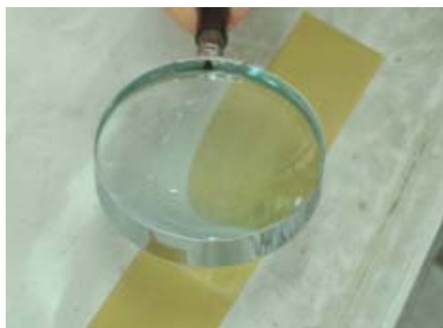
圖十、膠帶黏在壓克力板將擦拭後殘留棉絮黏起 圖十一、利用放大鏡觀察膠帶殘留棉絮量
