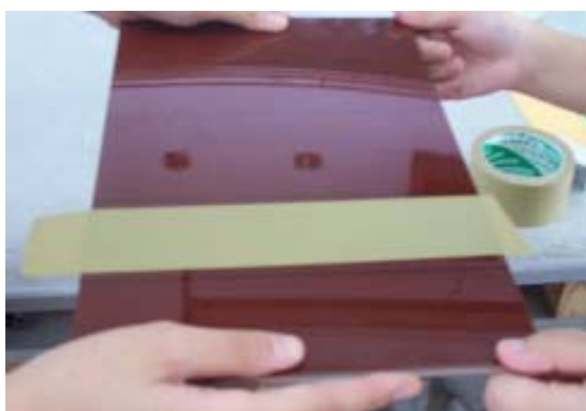
圖十、膠帶黏在壓克力板將擦拭後殘留棉絮黏起 圖十一、利用放大鏡觀察膠帶殘留棉絮量
