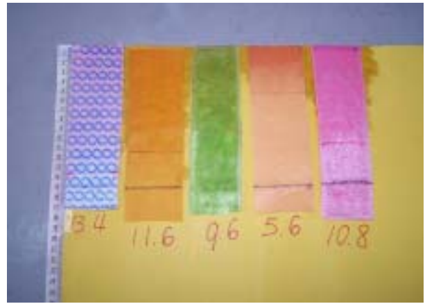
圖七、抹布吸水後測量水份上升之高度
