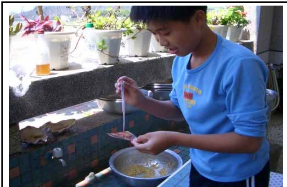
以蘇丹試劑測試油脂殘餘之分佈情形
