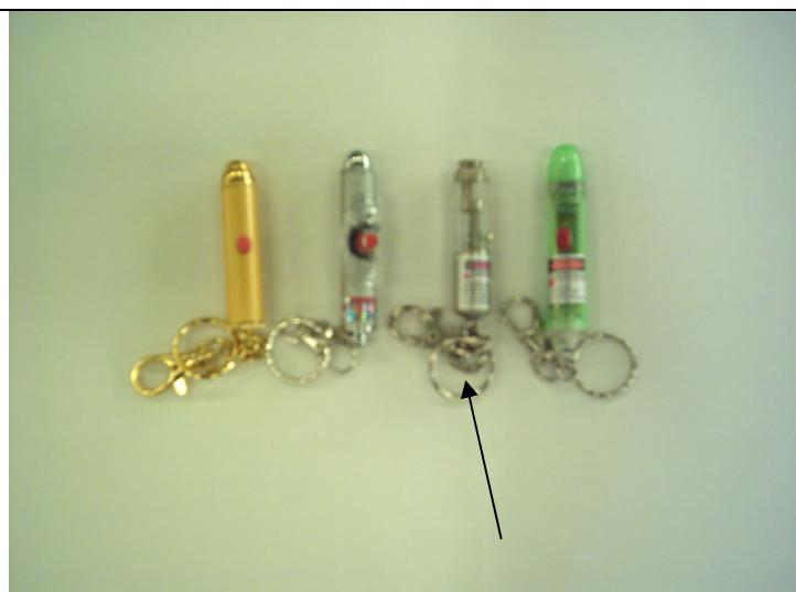
**照片一 A** 在各種雷射筆中，可旋轉調整焦距式的雷射筆，能將前面聚光凸透鏡鏡片拆下
