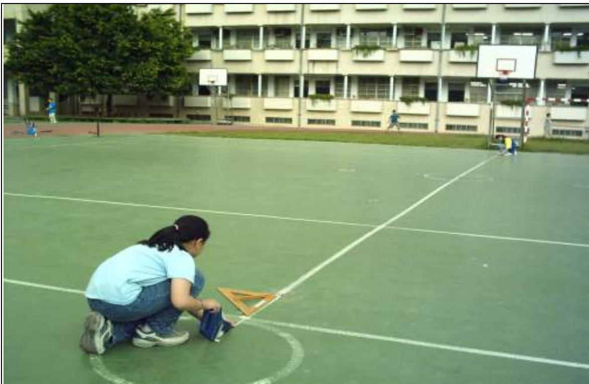
照片 六 把三角板擺平面式，讓雷射光點打到對角的樂樂棒球架上。可用它來檢測正方形、更便於計算面積、體積及周長
