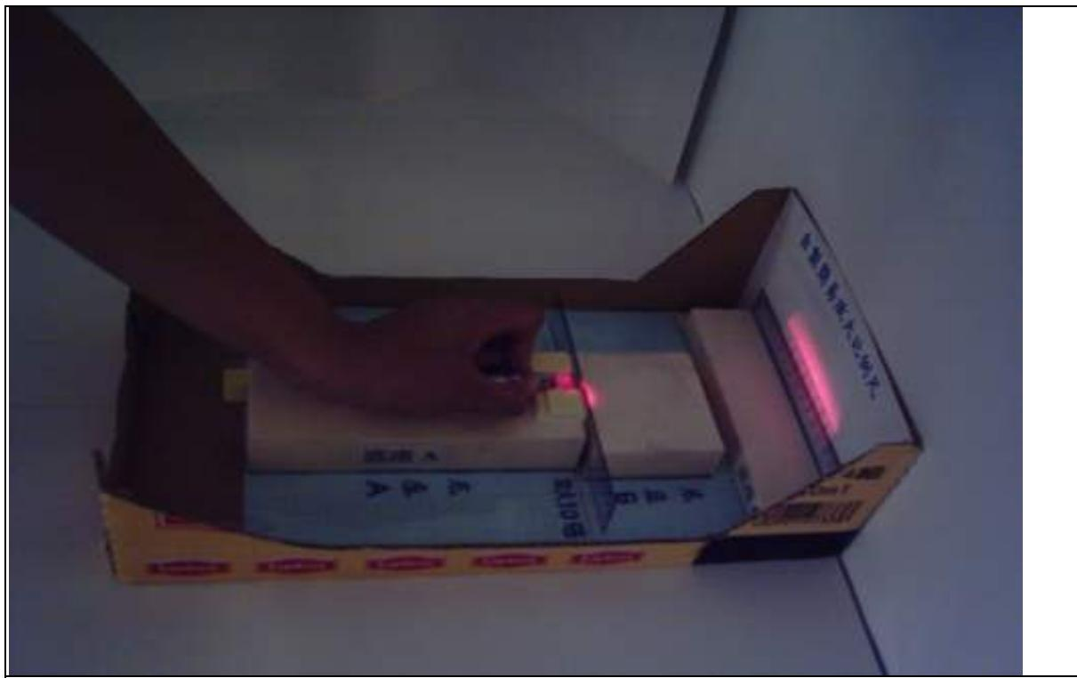
照片八-E 攜帶式簡易放大比例尺測量器
