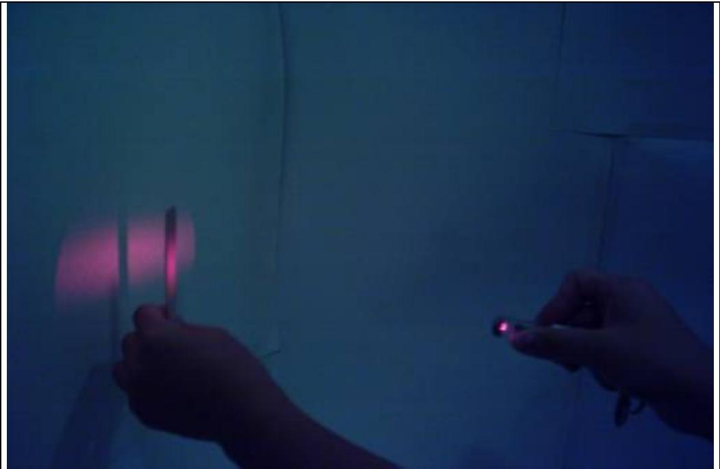
照片七 -C 雷射筆物體成像於接近布幕正前方，影像與實物一樣大小
