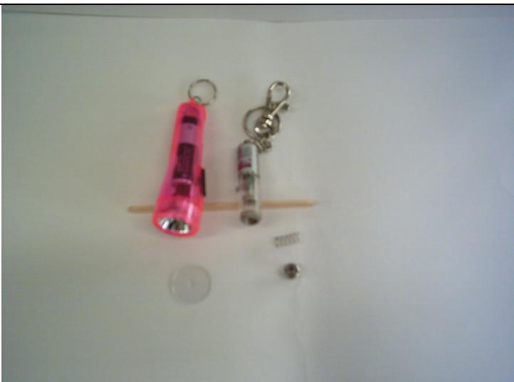
**照片一 B** 發現一般手電筒前面的鏡片為平面鏡，而雷射筆的為聚光透鏡，有微凸的形狀
