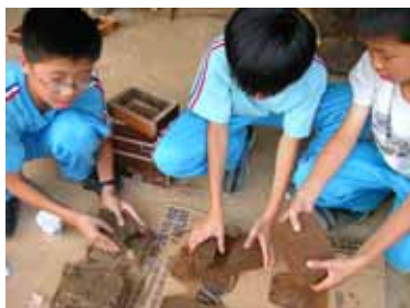
29.移動三種土磚的情形 (沙質、土質均破裂)
