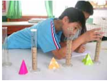
2. 各輕拍量筒五下 使細砂均平
