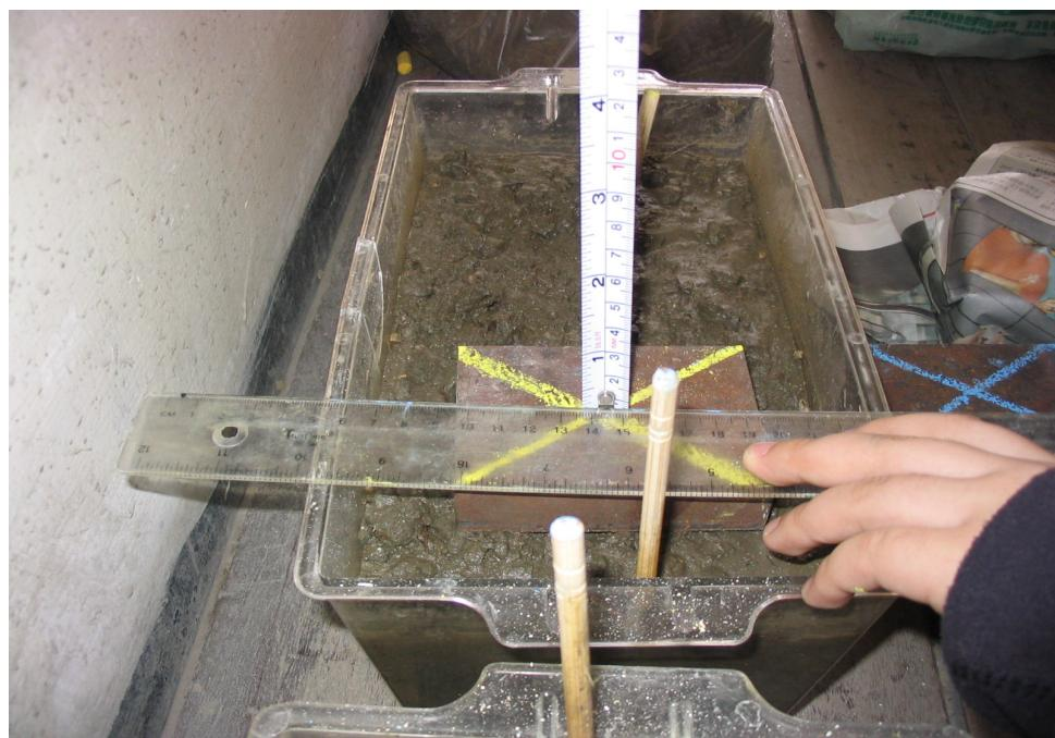
(圖七) 在吸水飽和與放水後，土壤表面物體高度之測量
