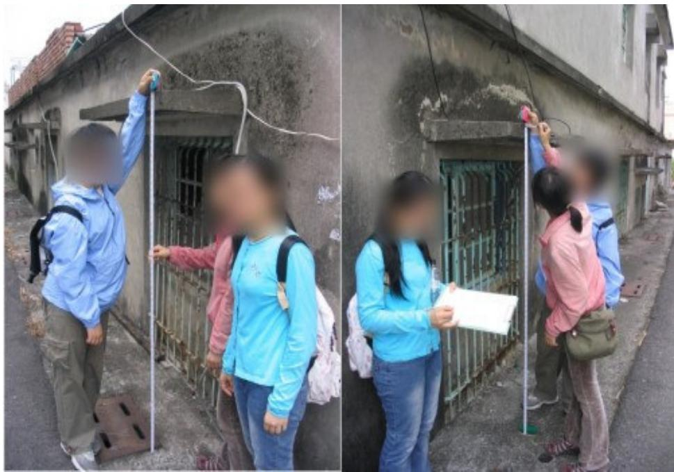
(圖十四) 測量結果證實右邊的二樓建築物下陷程度較多
