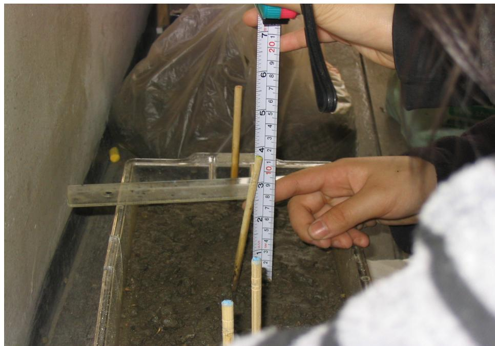
(圖五) 反覆加水放水之土壤高度測量
