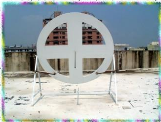
圖2.架設在本校頂樓的赤道式日晷南面
