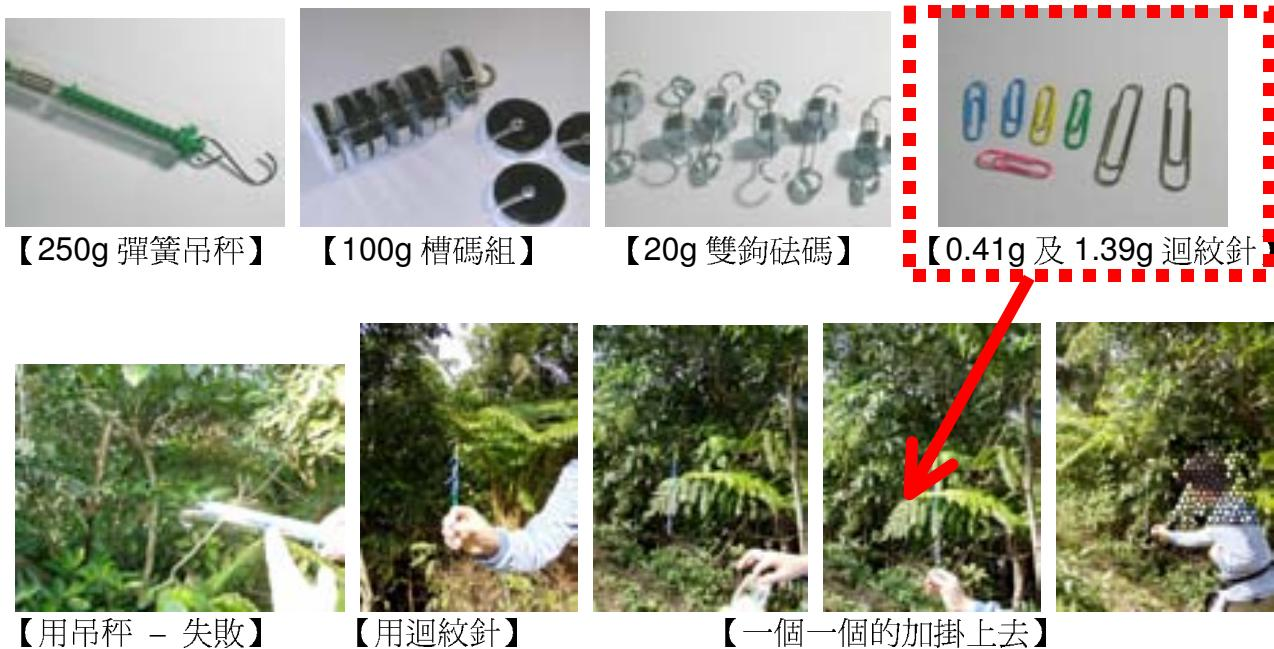
(五)、蜘蛛絲纏住人後被拉長不易斷的特性，做了蜘蛛絲的延展力實驗，每次取 30 公分長度網絲，固定一端，另一端隨著捲尺拉長，看拉到什麼程度才會斷裂。
