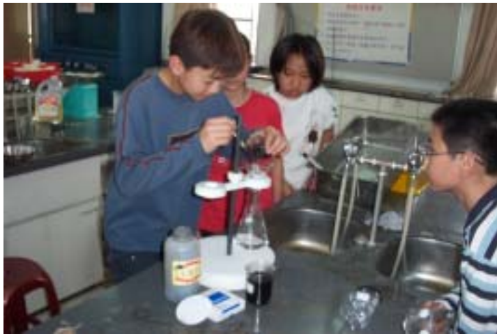
將廚餘廢油加入石墨脫色後再以濾紙過濾以準備製作果凍肥皂
