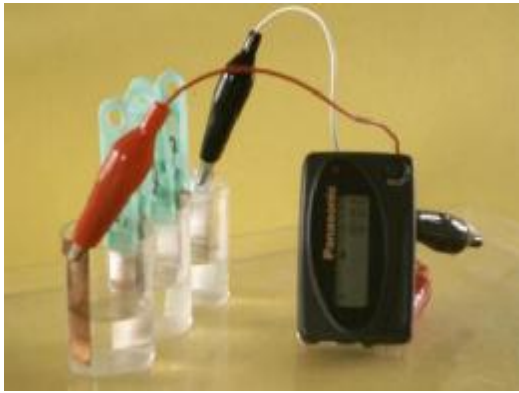
照片 12：串聯 3 杯漂白水電池，就能使用 Call 機
