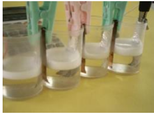
照片 13：使用穩潔(廚房強效)，使鋁片冒出許多氣泡
