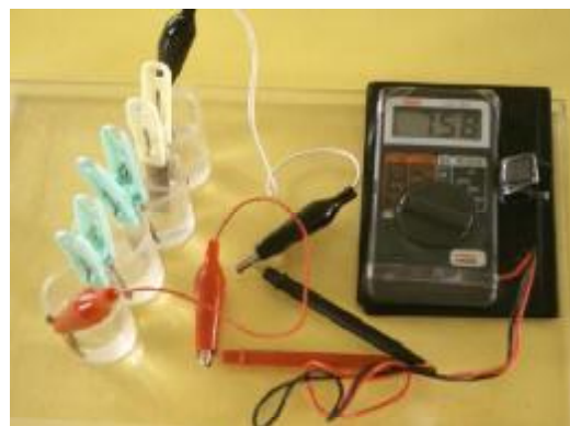
照片 7：測量倒入漂白水後的電壓
