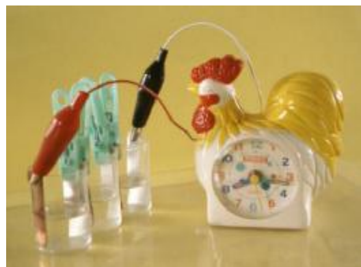
照片 15：串聯 3 杯漂白水電池，就能使用小鬧鐘
