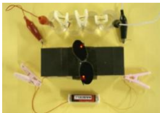
照片 11：串聯 4 杯濃鹽水(1.95V)和乾電池(1.5V) 使 LED 燈的亮度差不多
