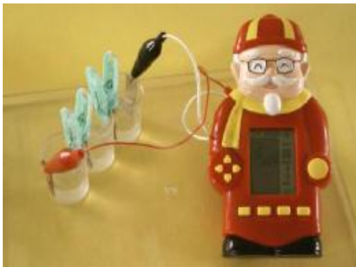
照片 14：串聯 3 杯漂白水電池，就能使用電動玩具
