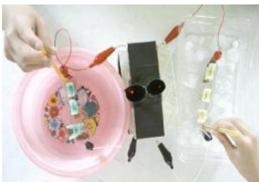
照片 10：比較 LED 燈的亮度 50°C 濃鹽水(左)、5°C 濃鹽水(右)
