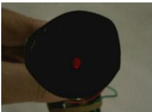
照片 4：在自來水中，LED 燈「微亮」
