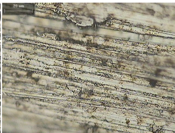
用電解法還原變白的銀片表面
