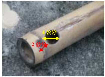
在竹筒未打穿端竹節上方二公分處鑿直徑約四公分圓孔
