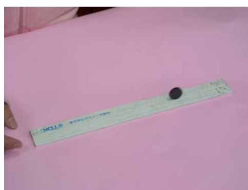
圖 4-4: 放手後，磁力車會因軌道的吸引而自動往前行駛。
