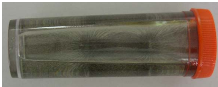
圖 3-9：從「立體磁力線儀」上方觀察磁力線的情形。
