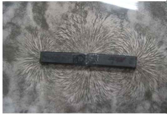
圖 3-6：棍棒形磁鐵-同極對同極-2
