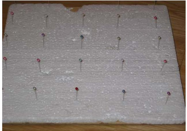
圖 7: 以珠針來模擬一般植物葉面之纖毛結構
