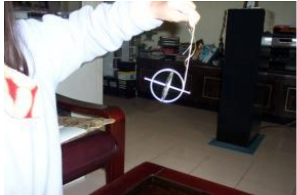
圖 47 陀螺儀吊繩旋轉不傾倒。
