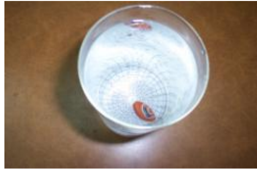
圖 19 橄欖球體在水中以曲線落下
