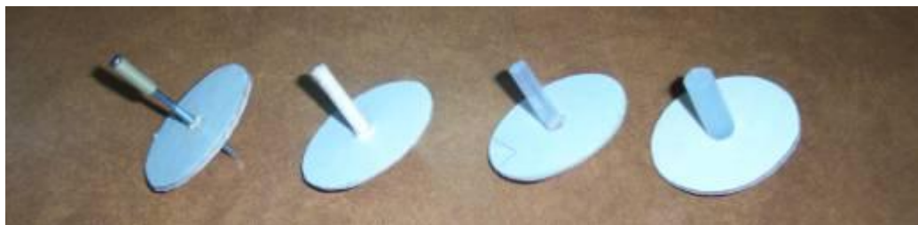
圖 9 3 \phi 鐵釘、5 \phi 木質、7 \phi 與 11 \phi 熱熔膠棒等軸桿的陀螺。
