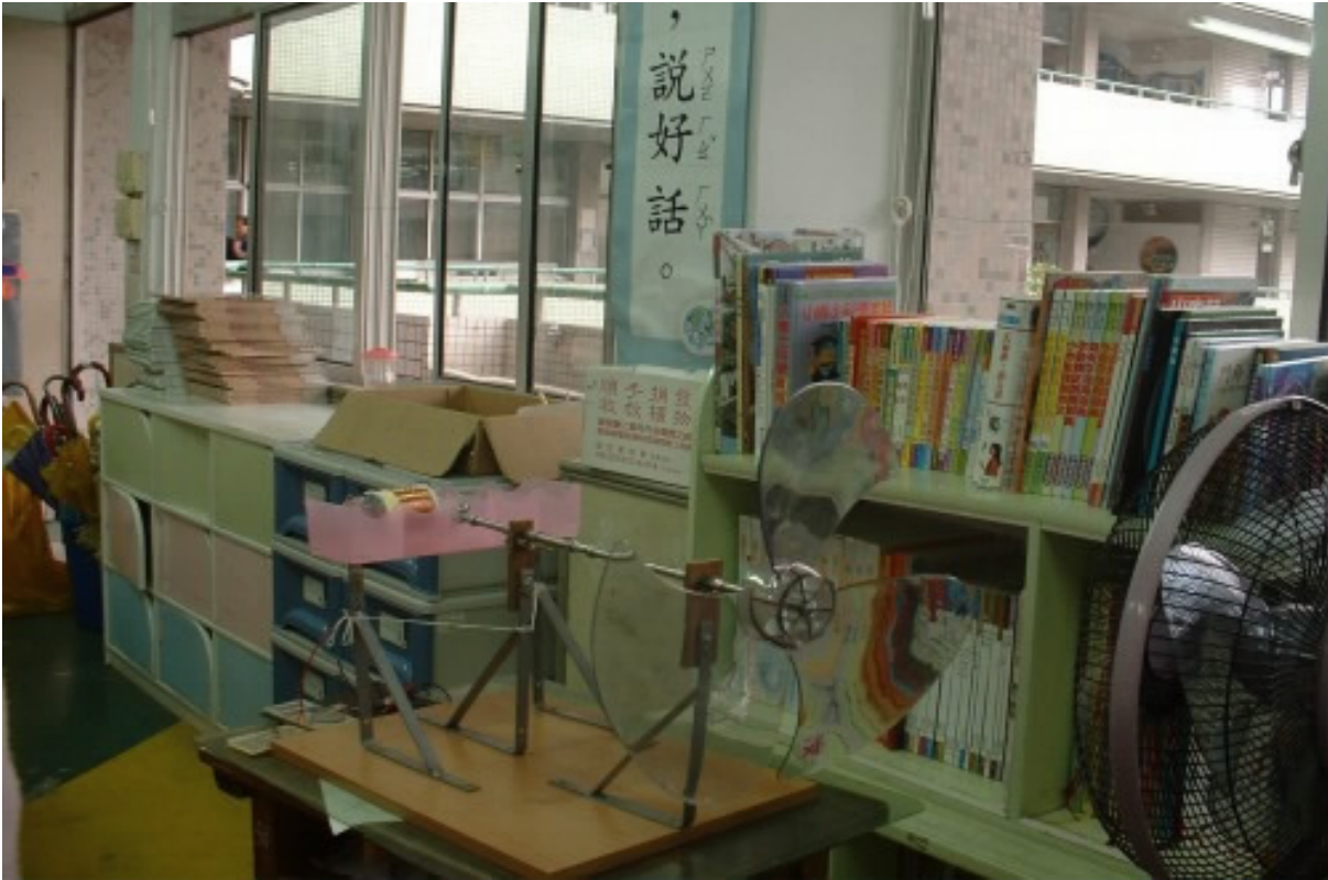
圖四、保持風力來源(電風扇)和發電機葉片之間的距離為 12.5 cm 和角度一定。
