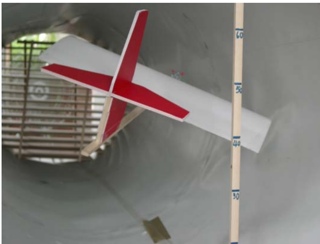
圖 5-16 機翼高度在 3.5 公分時,浮升高度最高,約 45 公分
