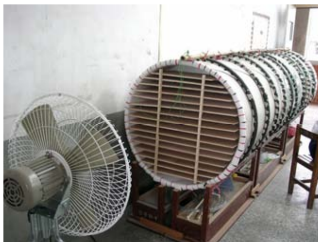
圖 5-5 風扇距離風洞口約一公尺
