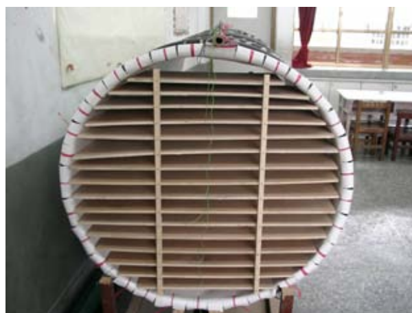
圖 5-4 風洞口的穩流葉片
