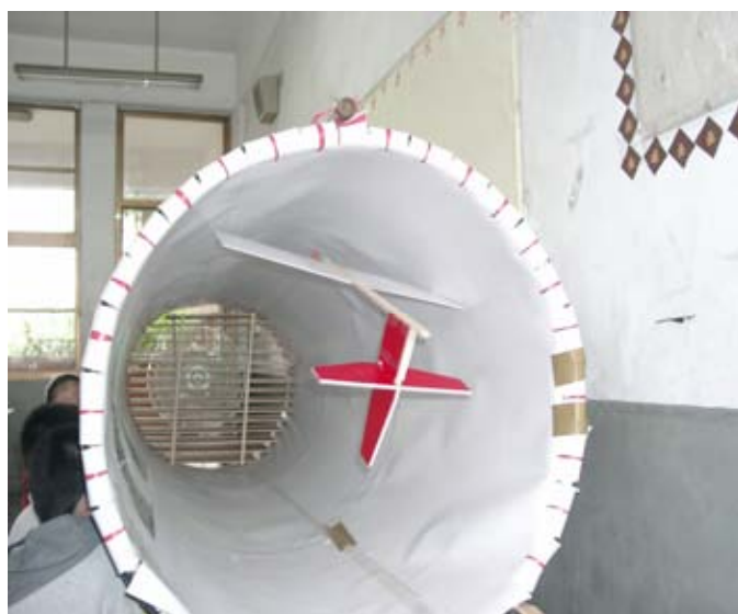
圖 5-29 沒有柏努力曲面的機翼正面向下時，飛機往上升起來。
