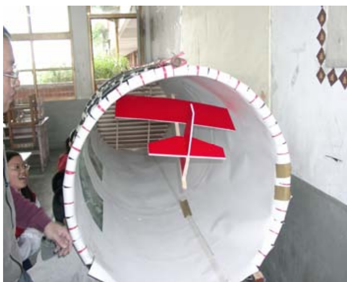
圖 5-28 沒有柏努力曲面的機翼正面向上時，飛機往上升起來。
