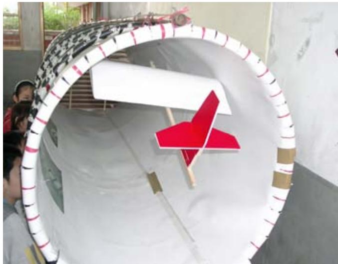
圖 5-26 柏努力的機翼正面向上時，飛機浮起來。
