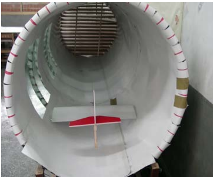
圖 5-14 將飛機放入風洞中準備測試
