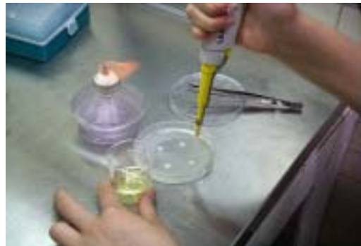
圖五 貼含有蔬菜萃取液的無菌濾紙圓片於含試驗菌液之培養基上，於 35°C 培養 24hr
