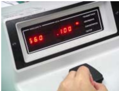
圖三 以分光光度計定量菌液於波長 660 nm 的吸光值為 0.1
