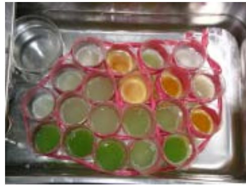
圖四 蔬菜汁置於恆溫水浴槽中以 45°C 濃縮萃取 6 小時
