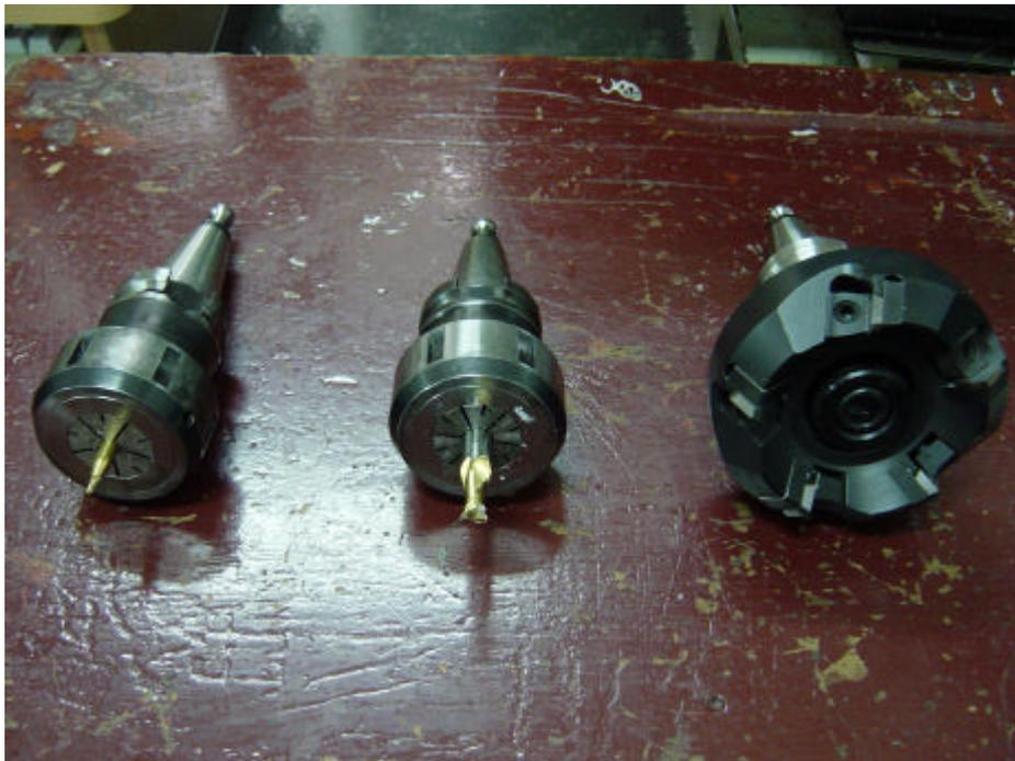
圖二 球刀、端銑刀、面銑刀加工刀具
