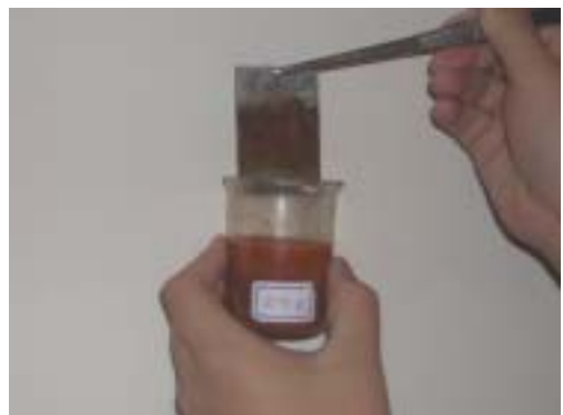
圖 15 未經修飾的鐵片浸泡 3 % \text{NaCl}_{(\text{aq})} 四週後，鏽蝕嚴重，且有剝落現象發生。
