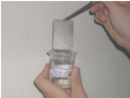
圖 12 以聚苯胺修飾的鐵片浸泡 3 % \text{NaCl}_{(\text{aq})} 一週後，仍無鏽蝕。
