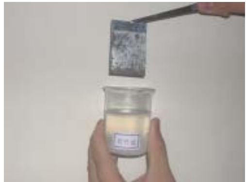
圖 13 未經修飾的鐵片浸泡 3 % \text{NaCl}_{(\text{aq})} 一週後，鏽斑增加許多。
