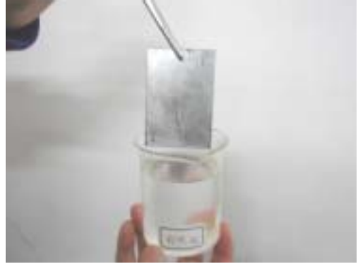
圖 11 未經修飾的鐵片浸泡 3 % \text{NaCl}_{(\text{aq})} 一天後，出現少量鏽斑。
