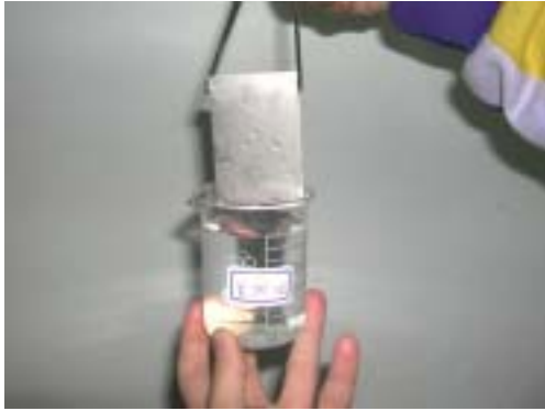
圖 10 以聚苯胺修飾的鐵片浸泡 3 % \text{NaCl}_{(\text{aq})} 一天後，無鏽蝕。
