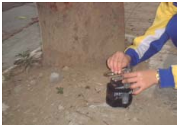
圖 29 以抽氣幫浦採取空氣樣品
